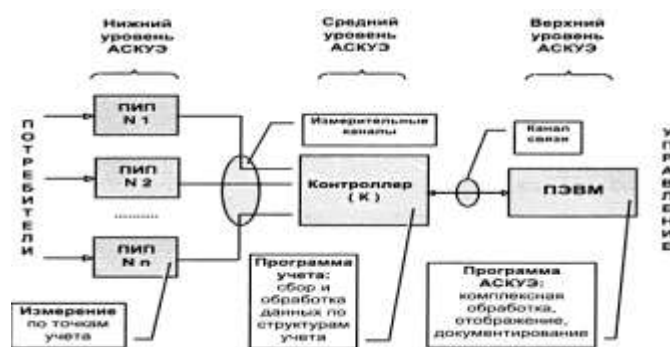
Рисунок 1. Трехуровневая структура АСКУЭ
