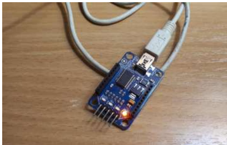
Сурет 6. ZigBee модульдерін бағдарламаға қосуға арналған Spark Fun бағдарламашысы
