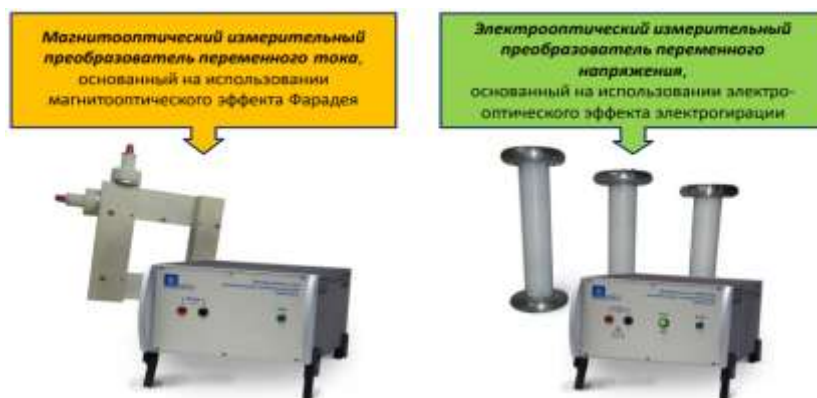
Рисунок 4. Примеры исполнения оптических измерителей тока и напряжения
