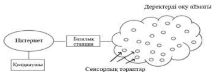
Сурет 2. Сымсыз сенсорлық желілердің құрылымы
