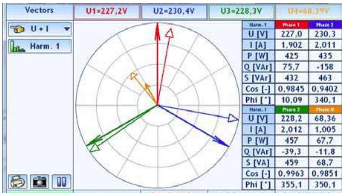
Рисунок 3. Пример вывода измерительной информации узла нагрузки трехфазной сети виртуальным прибором
