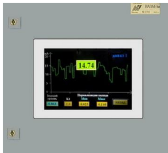
Рисунок 3.12 – Виброакустический анализатор загрузки мельницы «ВАЗМ-1М»
