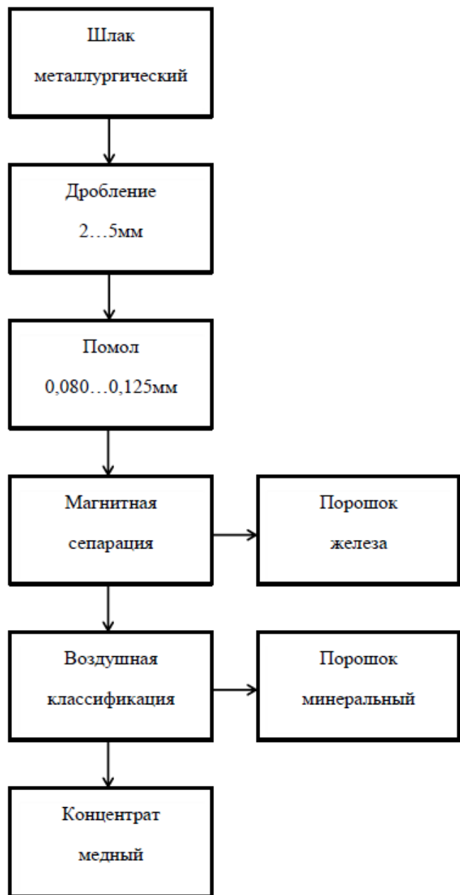
Рисунок 1.3 – Технологический процесс помола
