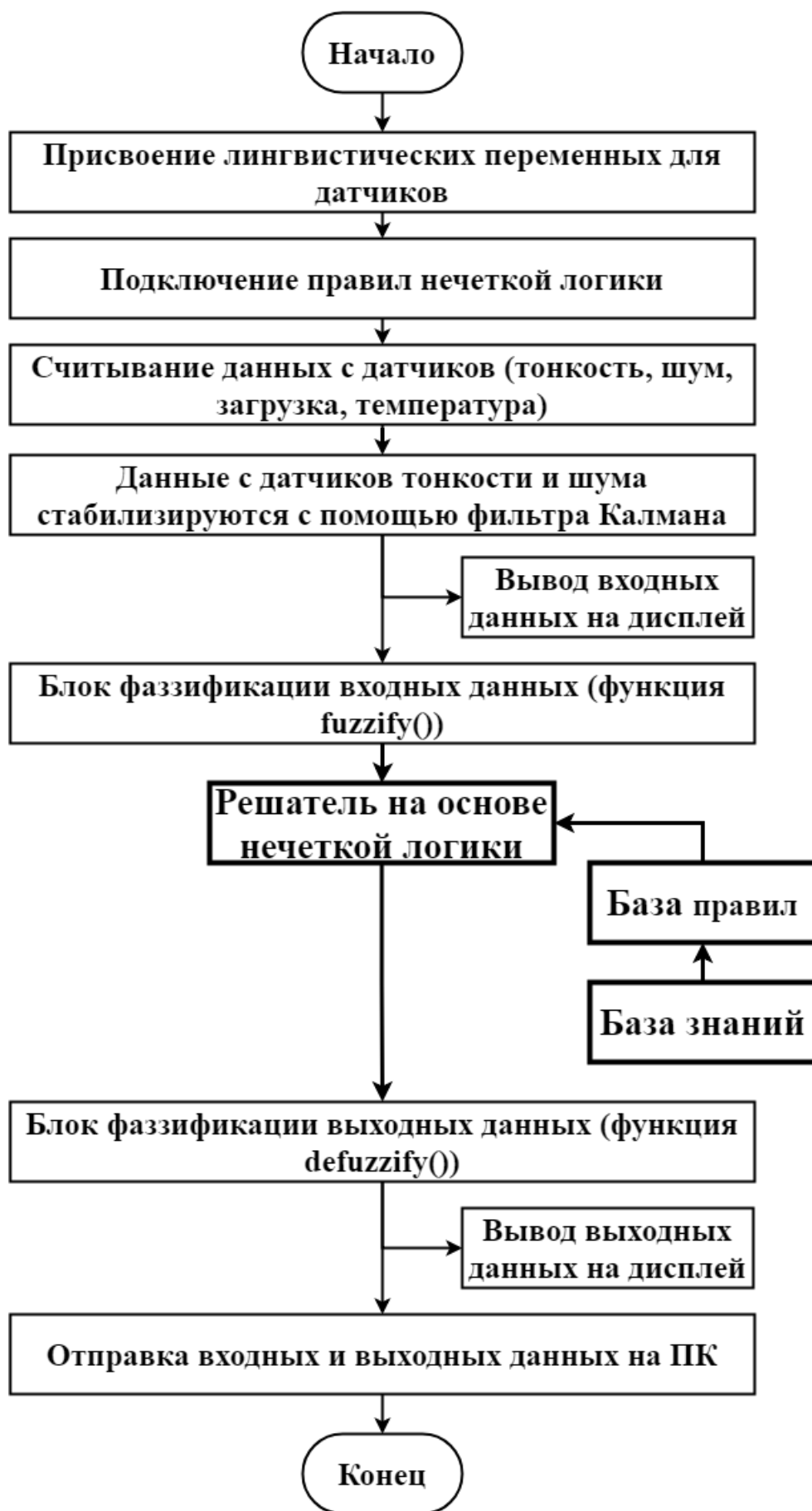
Рисунок 3.3 – Схема алгоритма реализации ввода вывода ключевой НЛ
