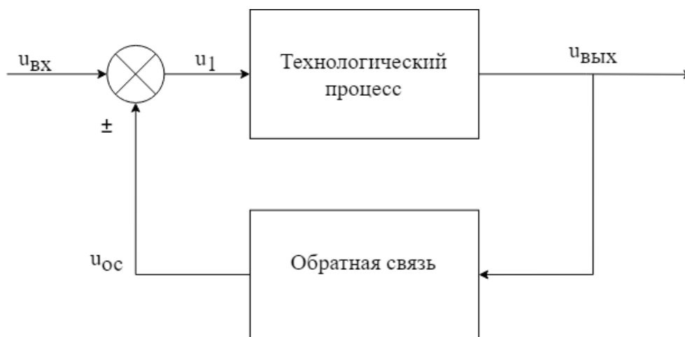
Рисунок 1.4 – Общая схема оптимизации для контроля обратной связи
