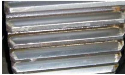
Рисунок 1.24 – Расположение пятна контакта равномерное по длине и высоте зуба
