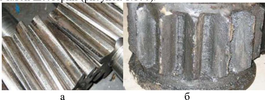
а) появление рисок на поверхности зубьев -начальная стадия абразивного износа; б) износа шестерни -предельная стадия абразивного
