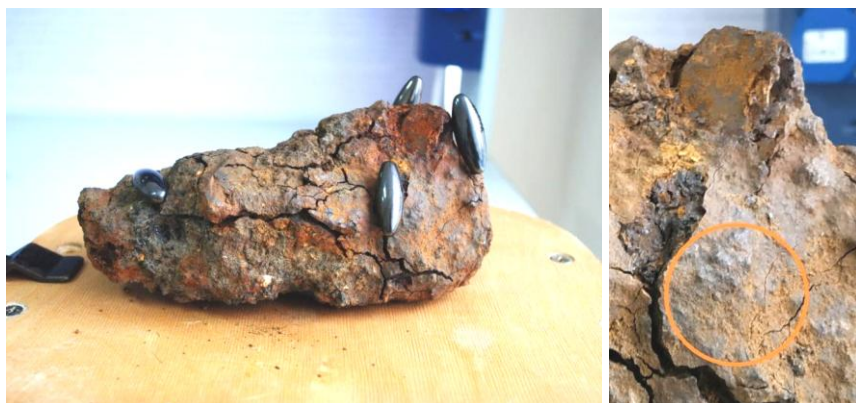
Рисунок 3 Магнитные свойства исследуемого тела (слева) и возможный участок коры плавления (справа)
