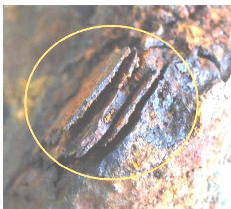
Рисунок 6 Пластинчатое (кристаллическое) расслоение окисленной металлической матрицы тела
